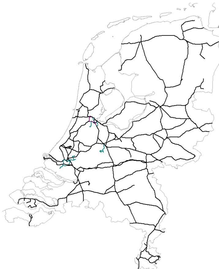
Figuur 2 Gezoneerde spoorlijnen vallen onder de Wet geluidhinder
