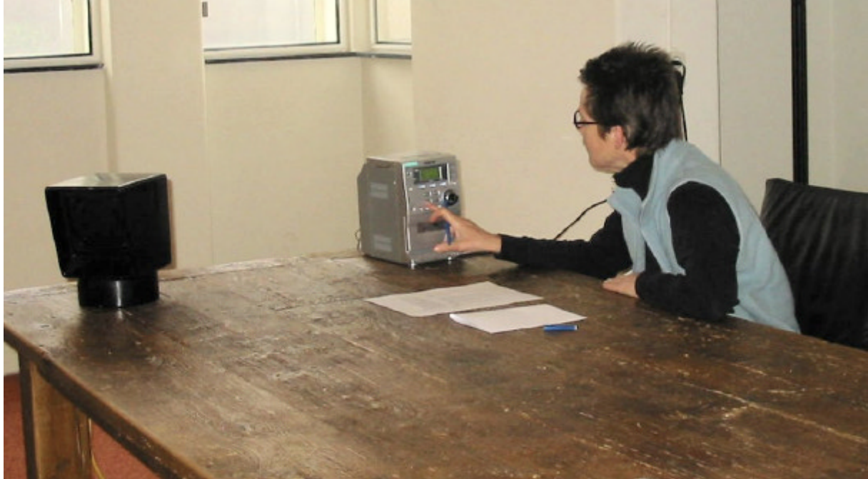
Figuur 3 Testopstelling met proefpersoon. De luidspreker van de elektronische overwegbel staat links op de tafel.
